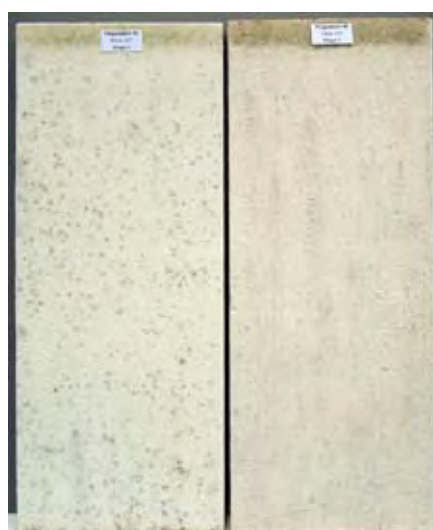
Färgsystem 40 Färgsystem 46 Caparol Schulz Alkyd Alkyd Lösningsmedel Lösningsmedel Panel 237 Panel 313 Mögel 5 Mögel 5
