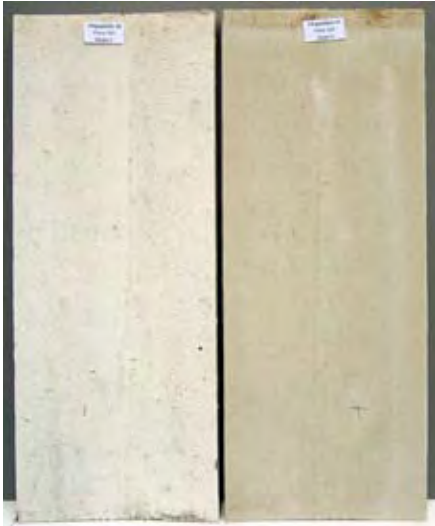
Färgsystem 29 Färgsystem 30 Norrön Nordsjö Alkyd Alkyd/linolja Lösningsmedel H 2 O Panel 583 Panel 562 Mögel 5 Mögel 4
