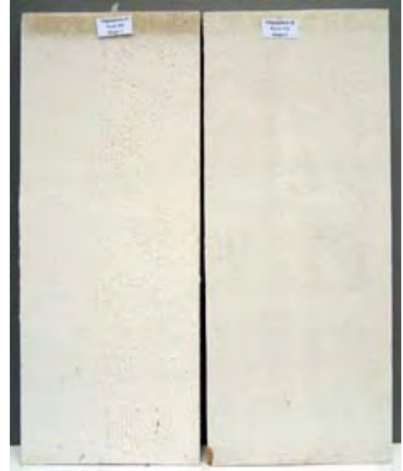
Färgsystem 21 Flügger Alkyd H 2 O Panel 546 Mögel 3 Färgsystem 26 Liwa Alkyd/akrylat H 2 O Panel 528 Mögel 3
