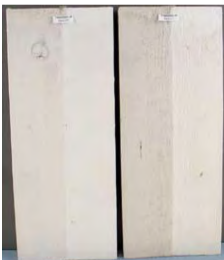
Färgsystem 29 Färgsystem 30 Norrön Nordsjö Alkyd Alkyd/linolja Lösningsmedel H 2 O Panel 207 Panel 211 Mögel 2 Mögel 2
