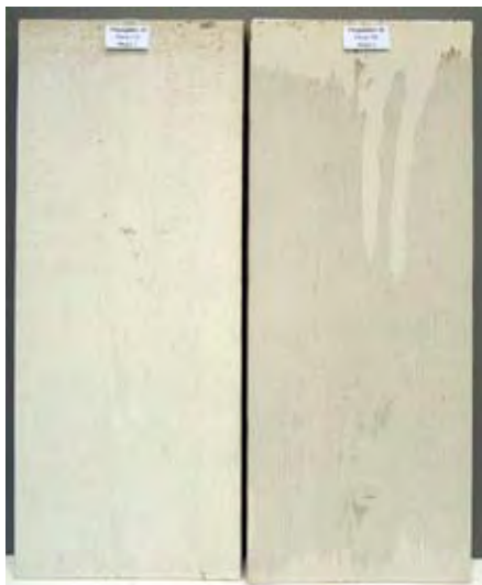
Färgsystem 29 Färgsystem 30 Norrön Nordsjö Alkyd Alkyd/linolja Lösningsmedel H 2 O Panel 112 Panel 182 Mögel 3 Mögel 5
