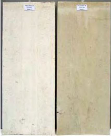
Färgsystem 29 Färgsystem 30 Norrön Nordsjö Alkyd Alkyd/linolja Lösningsmedel H 2 O Panel 672 Panel 800 Mögel 4 Mögel 5
