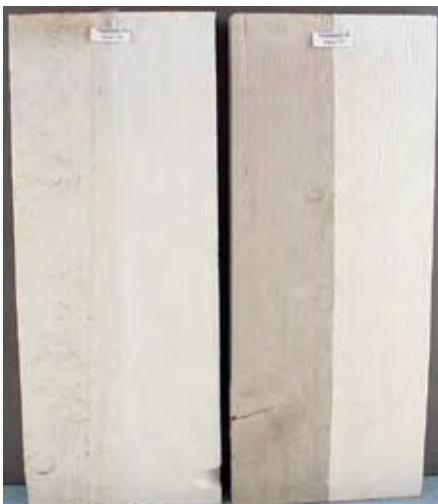
Färgsystem 29 Färgsystem 30 Norrön Nordsjö Alkyd Alkyd/linolja Lösningsmedel H 2 O Panel 110 Panel 117 Mögel 2 Mögel 3
